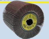
Rueda abrasiva con láminas rectas para el lijado fino de superficies. Las laminillas están dispuestas radialmente en forma de abanico. Esto facilita la adaptación perfecta al contorno de la pieza trabajada
