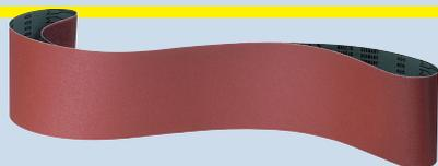
Tejido abrasivo con soporte poliéster y revestimiento granular abierto de óxido de aluminio indicado para el lijado de calibrado e intermedio. La tecnología ACT y los ingredientes antiestáticos evitan el embozamiento prematuro
