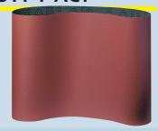
Tejido abrasivo con soporte poliéster y revestimiento granular abierto de óxido de aluminio indicado para el lijado de calibrado e intermedio. La tecnología ACT y los ingredientes antiestáticos evitan el embozamiento prematuro
