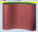
Tejido abrasivo especialmente resistente al desgarro y de muy alto rendimiento y alta durabilidad, gracias a los granos autoafilantes cerámicos. Especialmente indicado para acero inoxidable y de alta aleación
